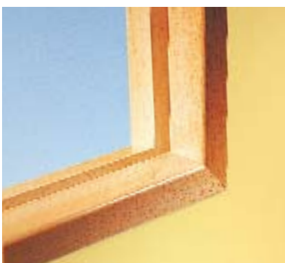
För 16 mm brandskyddsglas. Brand-/ljudklass EI 30/35 dB samt brandgastäthetsklass S_a och S_m .
