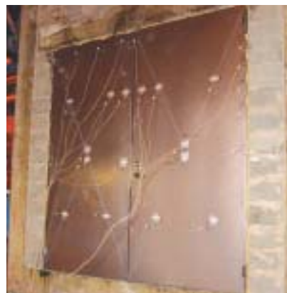
Fig 3. Uppställd Daloc branddörr under brandprov.
