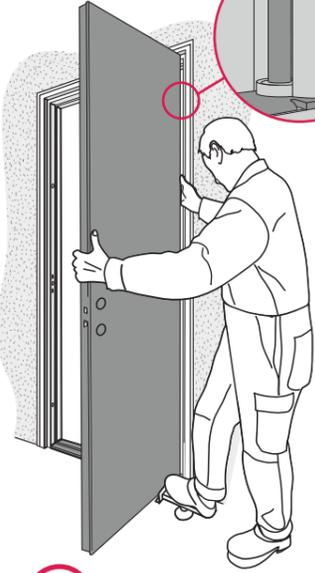
Achten Sie darauf, dass der Spalt zwischen Türblatt und Zarge gleichmäßig ist. Der Spalt wird durch die Justierung der Montagehülsen eingestellt.
