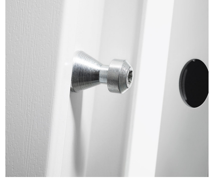
Die Rückseite des Türblatts ist mit hakenförmigen Stahlzapfen ausgerüstet, die bei einem Einbruchversuch in die verstärkte Zarge greifen.
